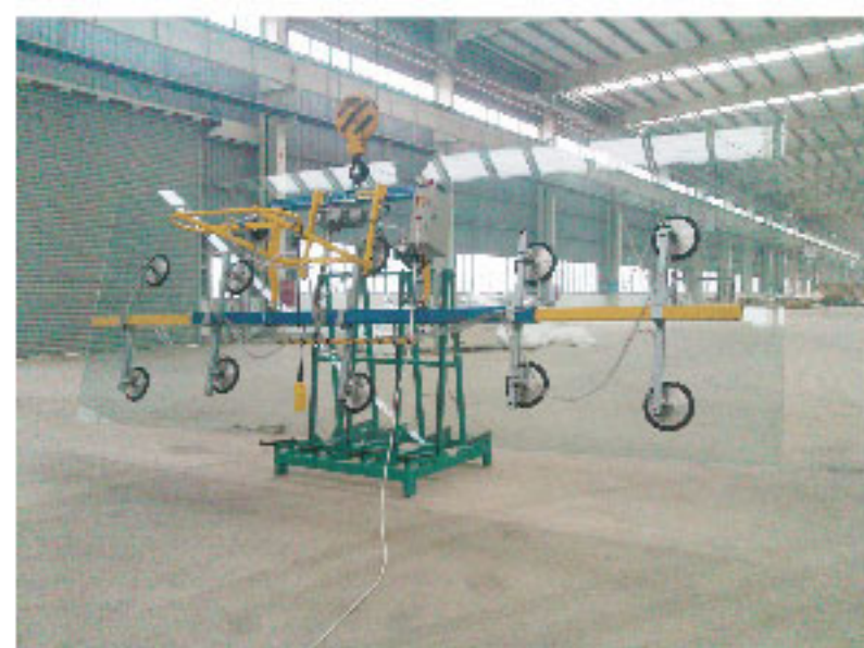
太仓台玻项目, 玻璃加工90度翻转 Glass Electrical Swiveling 1200kg
